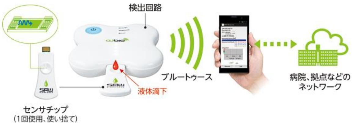
図 11 SAWバイオセンサコンセプトモデル
